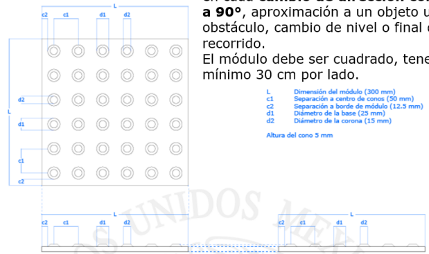
Figura 4 - Dimensionamiento de guías de dirección
